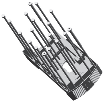
图7 推管和推杆设计图
